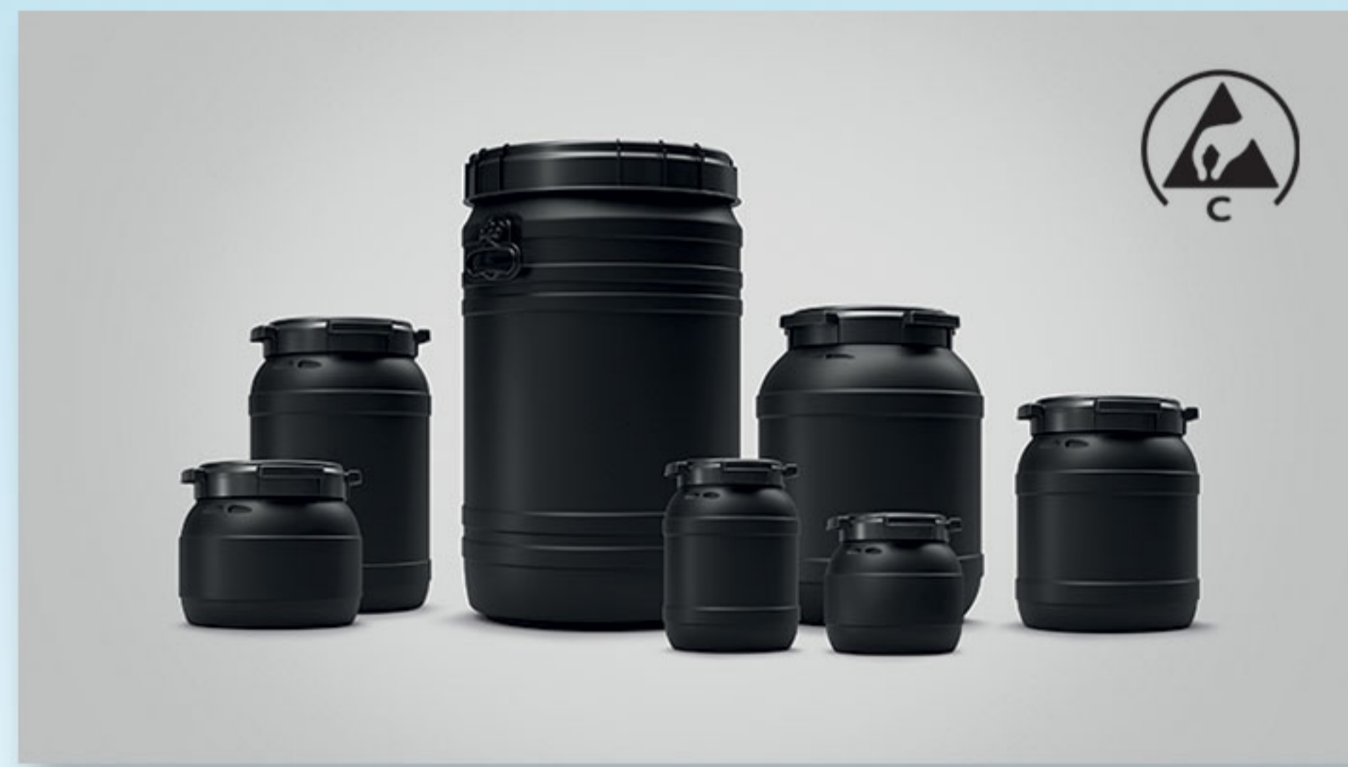
Leitfähige Fässer Mit Schraubdeckel 3,6|6|10|15|20|26|75 Liter Oberflächenwiderstand \leq 1.000.000 Ohm Wasserdampf- und leckdicht UN-zertifiziert (1H2) für feste Stoffe Leitfähiges HDPE (nicht lebensmittelecht)
