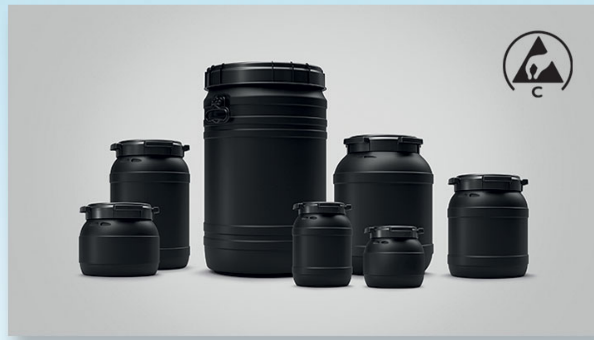
Geleidende vaten Met schroefdeksel 3,6|6|10|15|20|26|75 liter Oppervlakteweerstand ≤1.000.000 Ohm Waterdamp- en lekdicht UN-gecertificeerd (1H2) voor vaste stoffen Geleidende HDPE (niet levensmiddelengeschikt)
