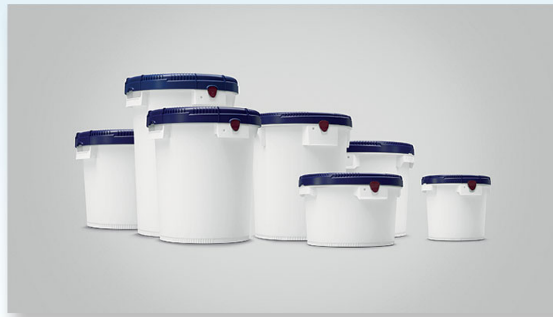
Click Pack emmers Met schroefdeksel 6|10|15|20|25 liter Openen en sluiten met een kwartslag Waterdampdicht UN-gecertificeerd (1H2) voor vaste stoffen HDPE
